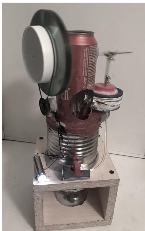
Рис.1. Внешний вид модели двигателя Стирлинга
